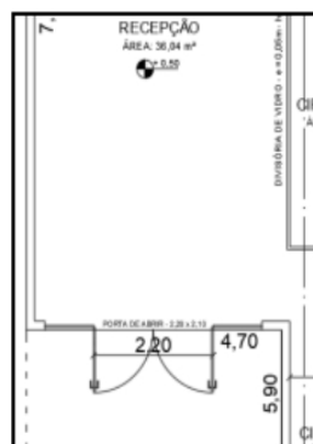
Imagem 02: Instalação Nova porta de abrir
